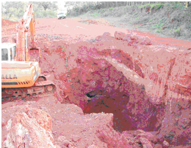
Figura 2. Porción central del yacimiento El Palotal, en el que se observa hematina masiva de textura escoreacea intercaladas con tobas felsicas.
