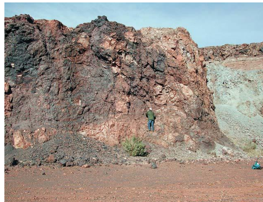
Figura 6. Parte superior de un cuerpo de brecha mineralizada expuesto en la parte NW del tajo. En color rosa claro se observan bloques de riocacita y el color negro corresponde a la magnetita.
