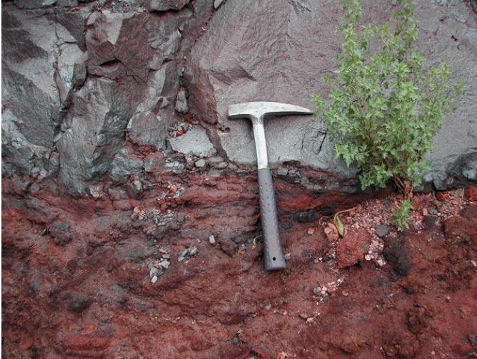
Figura 4. Contacto inferior de un cuerpo de mineral de hierro masivo ubicado al sur del tajo con la riocacita de la Formación La Perla.
